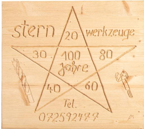
Freihand - Anwendungsbeispiel für Schriftenfräser 562AE/VHW-8/60
